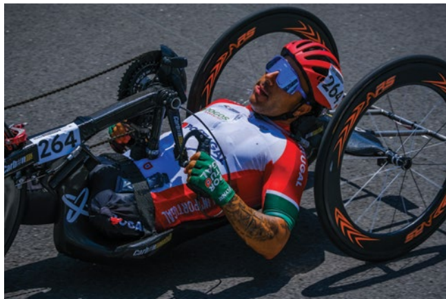
Fig. 8: Handbike com proteção de corrente, barra de segurança na parte traseira e sistema duplo independentemente de travagem na roda dianteira.
