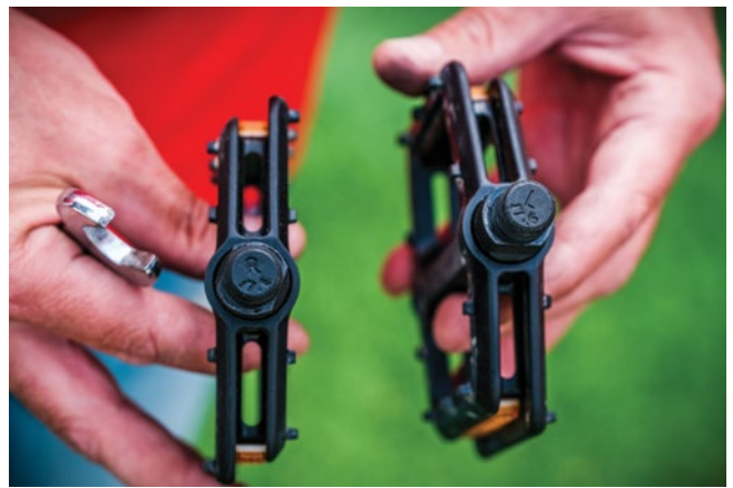
Fig. 53: Identificação do lado dos pedais: esquerdo (L) e direito (R).
