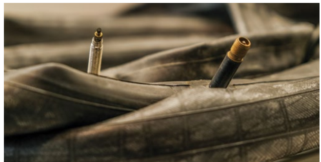
Fig. 18: Câmara de ar de válvula fina - presta (esquerda); câmara de ar de válvula grossa - schrader (direita).
