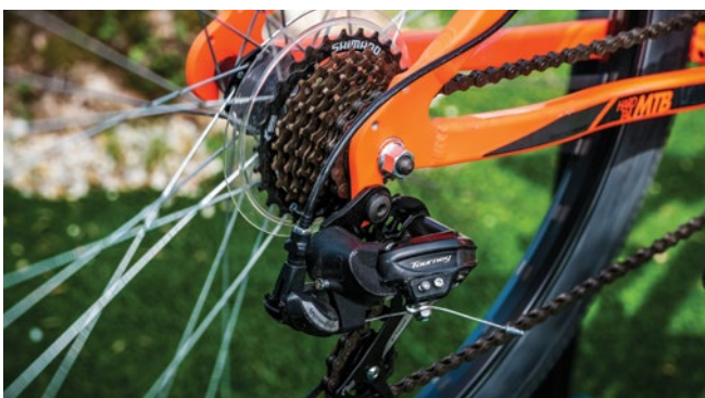
Fig. 24: Correta colocação da corrente para retirar a roda de trás.
