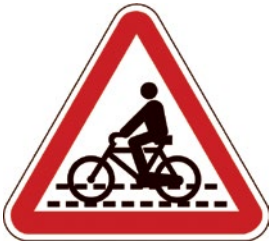
Fig. 9: Sinal de perigo - Passagem para velocípedes.
