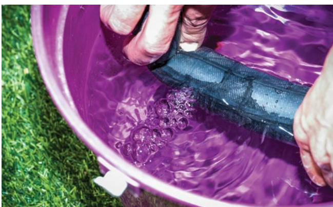
Fig. 29: Câmara de ar dentro de água para localizar o furo.
