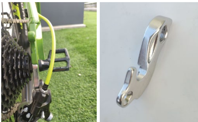
Fig. 43: Dropout em ótimas condições.
