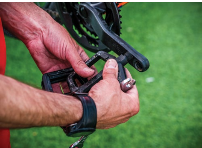
Fig. 52: Colocação dos pedais.
