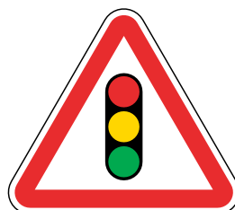
Fig. 7: Sinal de perigo - Sinalização luminosa.
