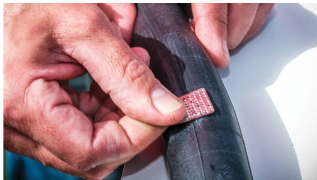
Fig. 30: Lixar o local do furo para limpar impurezas.
