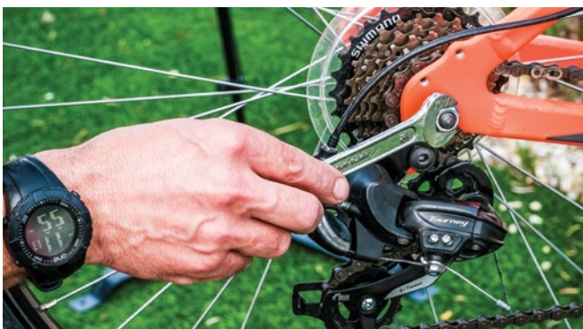
Fig. 25: Desapertar a roda de trás com chave de bocas.
