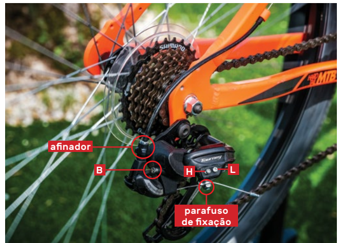
Fig. 42: Desviador traseiro - os cinco pontos reguladores (parafusos de afinação H, L e B, afinador/tensor e parafuso de fixação do cabo).
