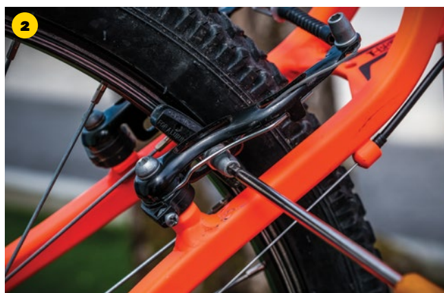
Fig. 38: Constituição de sistema de travão V-brake : a manete (em cima) e o braço do travão (em baixo).
