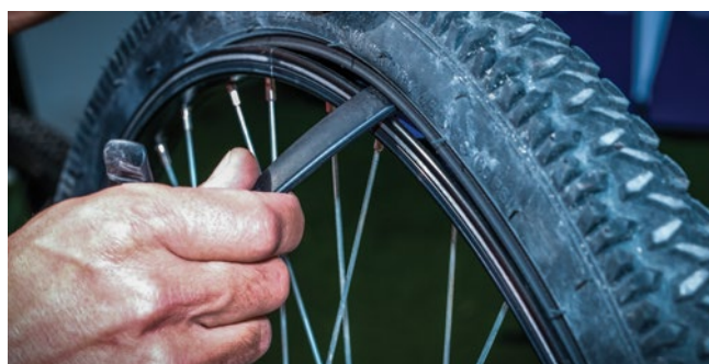
Fig. 27: Utilização dos desmonta pneus para facilitar a saída do pneu.
