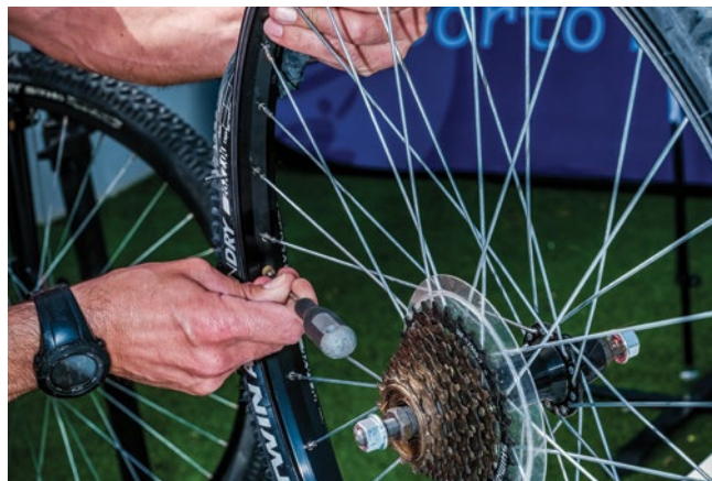
Fig. 26: Esvaziar completamente a câmara de ar para facilitar o trabalho.
