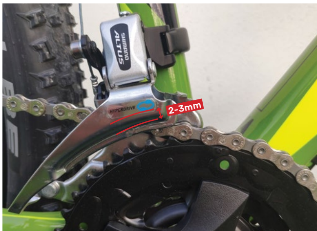
Fig. 46: Correto posicionamento do desviador dianteiro.
