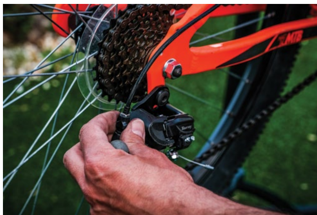
Fig. 45: Regulação da tensão do cabo no afinador.
