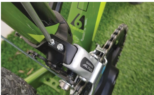
Fig. 47: Ajuste dos parafusos limitadores L e H.
