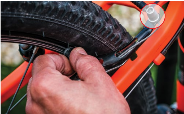
Fig. 39: Correção da posição dos calços e o ponto de afinação assinalado com círculo.
