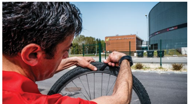
Fig. 35: Momento final da colocação do pneu com a ajuda dos desmonta pneus.
